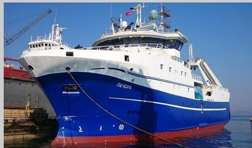
Траулер для ООО «Андег», ГД W6L32, редуктор, валолиния с ВРШ, система управления ВРШ
