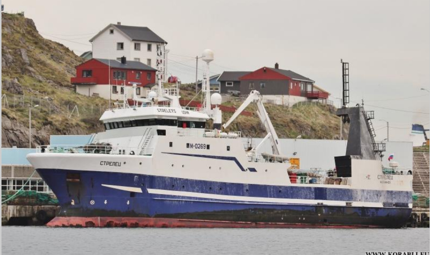
2 траулера для Мурмансельдь-2 и Эридан, ГД W9L32, редуктор, валолиния с ВРШ, система управления ВРШ (постр. в Хорватии)
